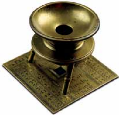
Promhadóir línéadaigh, Seward, Baile Átha Cliath, lár na 18ú haoise. Méadaitheoir a d'úsáidí chun dlús snáitheanna i línédach a thomhas chun críocha rialú cáilíochta.
